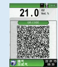
**+** 内置二维码功能，每组测量值都能生成一个二维码，通过 Eursoft connect APP 扫描二维码后可将数据直接保存于手机。
