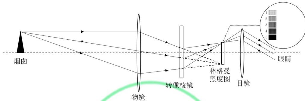
图1 林格曼望远镜光路原理示意图
